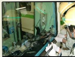
電車正面のガラスを新しく取替。外れないようにゴムで止めます。
