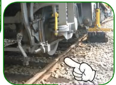
③ 車輪を浮かせて、レールに乗せます。
