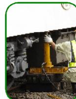
③ 車両の脱線復旧 ← シッカリ確実にジャッキを固定します。
