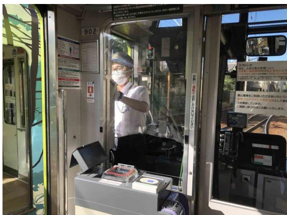
運転台後方に遮蔽シート設置
